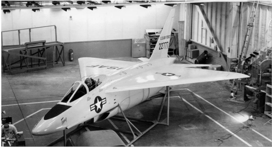
Рис. 1.2 Макет лёгкого истребителя N-102 Fang – считается "дедушкой" F-5
