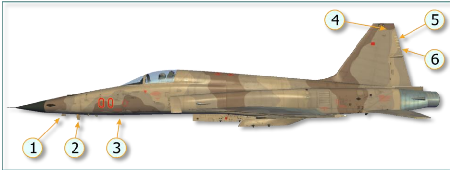
Рис. 6.19 Расположение антенн на самолёте
