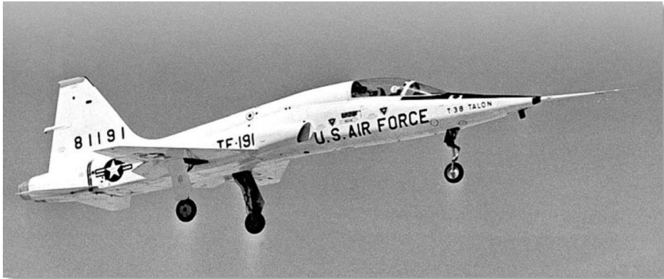
Рис. 1.5. Первые три УТ-38 часто летали с закрытым задним фонарём. В задней кабине располагалось различное контрольно-измерительное оборудование
