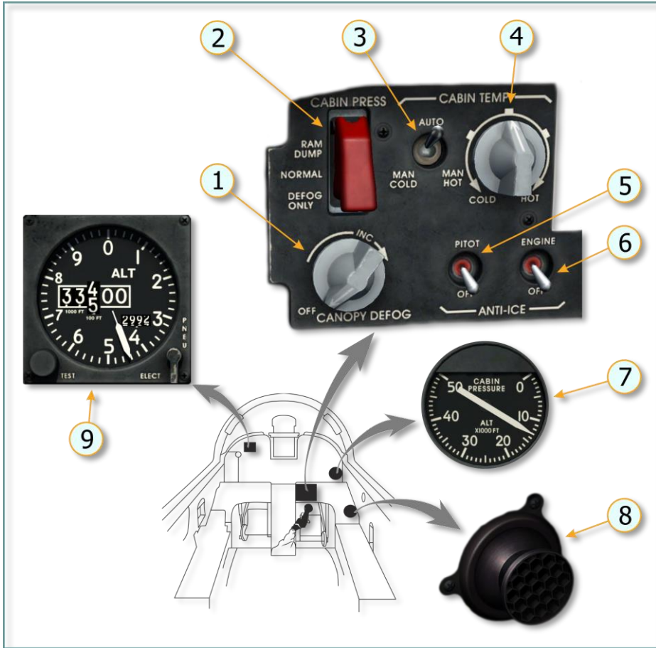
Рис. 6.17 Управление и индикация системы жизнеобеспечения в кабине
