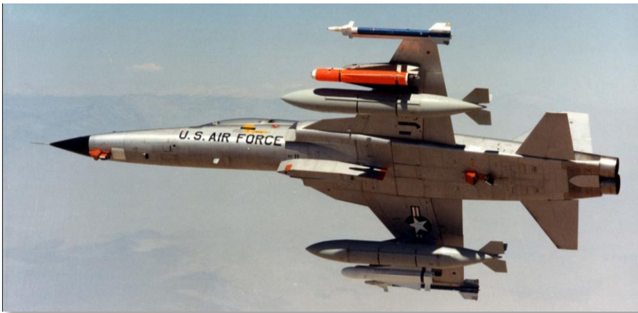
Рис. 1.27 F-5F с подвесными баками, ракетами Maverick и Sidewinder. Оранжевая коробка под носом представляет собой камеру для записи применения оружия
