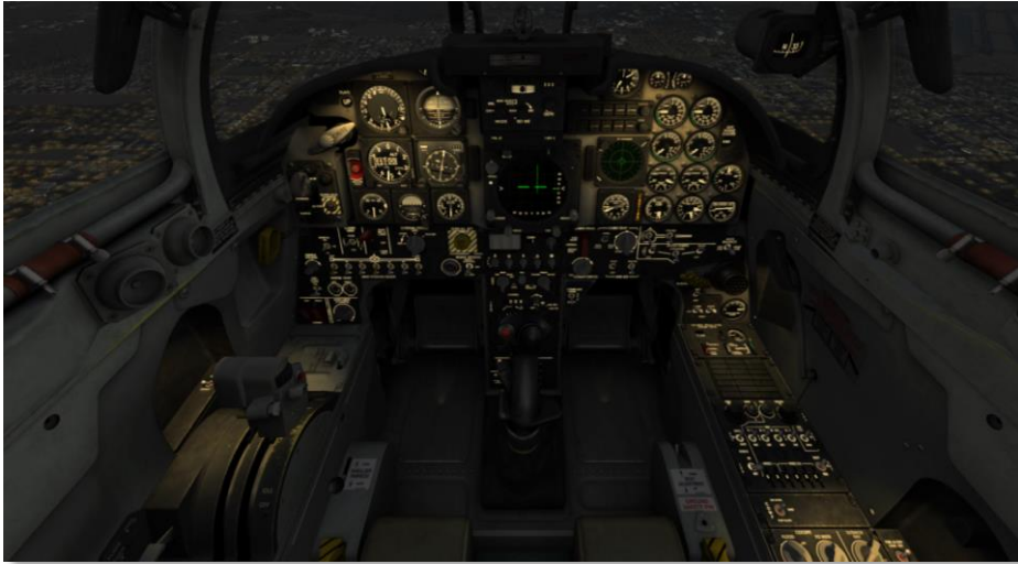
Рис. 6.14 Дополнительное (аварийное) освещение кабины
