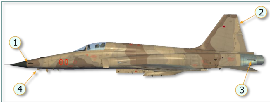
Рис. 7.14 Расположение антенн AN/ALR-87 на самолёте
